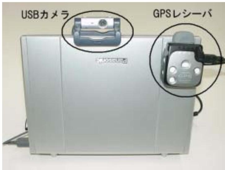
図2 . コラボマップクライアント用コンピュータの背面から見た様子
